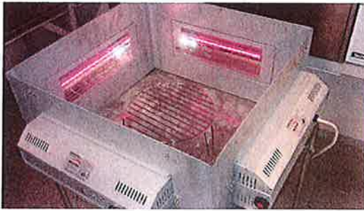
I) Förberedning av infravärmningsskåpet
