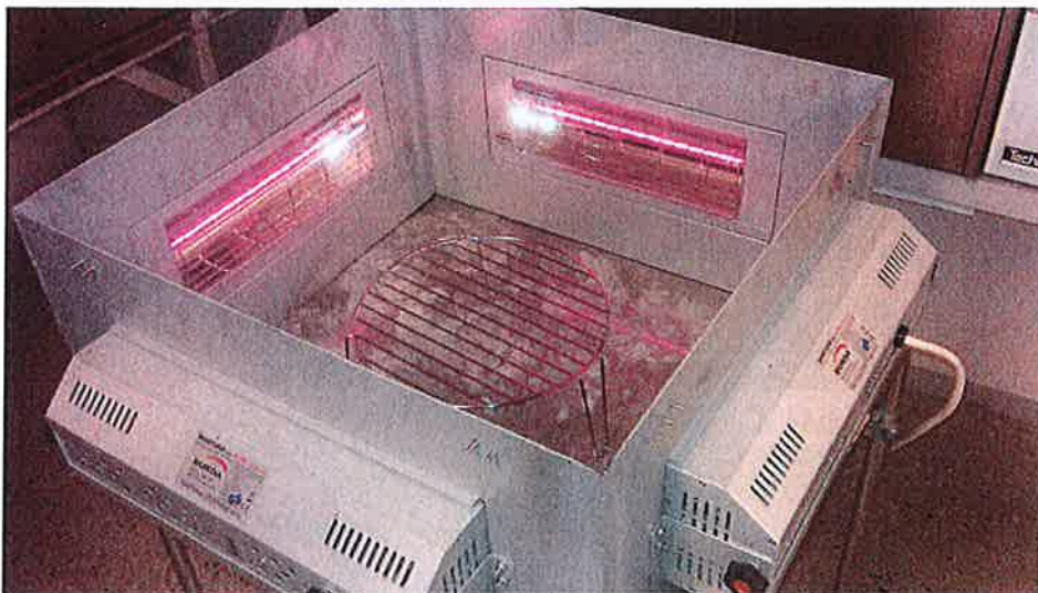
Bild 9: Infravärmningsskåp består av 4 enskilda delar SMART 2000 (2000W effekt)
