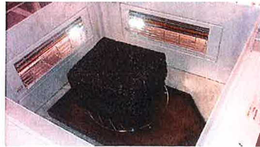
II) Provet installerad i infravärmningsskåpet
