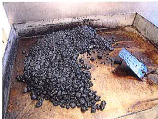
Bild 8: Blandning av asfaltmassa på varmt bordet.
